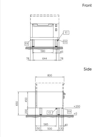
Electrical inlet (power) Equipotential screw
